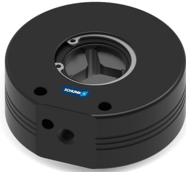
Mit den neu entwickelten Spannvorrichtungen TRIBOS-SVP Mini und TRIBOS-SVP RM lassen sich in Sekundenschnelle Werkzeuge wechseln. Spannvorrichtung auf TRIBOS-Mini oder TRIBOS-RM aufsetzen, Werkzeug einfügen, auf Anschlag spannen – fertig. Dank des voreingestellten Drucks ist das Werkzeug schnell und prozesssicher gespannt. Das spart Zeit und reduziert die Rüstkosten deutlich.
